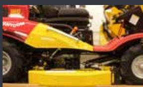
Réglage du plateau de coupe depuis le siège conducteur en 21 positions, assisté par un vérin à gaz.
