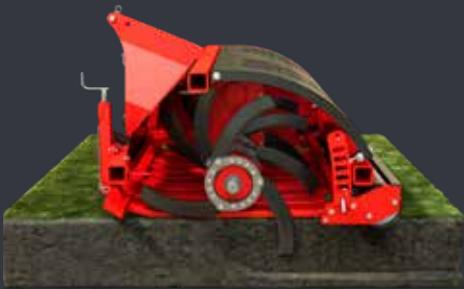
Les lames des Verti-Quake s'enfoncent alternativement dans le sol sur toute la largeur de la machine pour découper des sections verticales tout en vibrant horizontalement. Chaque section est bousculée par le passage des lames en décalé à sa droite et à sa gauche d'où l'effet de « décompaction ».
