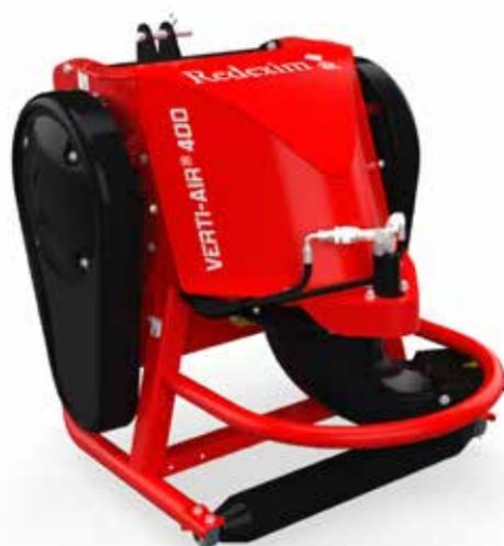
Les Verti-Air 400 sont des souffleurs puissants et polyvalents, avec de **multiples options d'attelage**. Ils éliminent débris et herbe coupée tout en respectant un **niveau sonore bas**. La buse est orientable de droite à gauche, les commandes accessibles depuis le siège conducteur, et le rouleau anti-scalp et la barre antichocs protègent la machine et le terrain.
