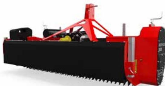
**Disponibles en 3 largeurs de travail**, les Verti-Cuts scarifient jusqu'à **50 mm de profondeur** à une vitesse maximum de 7km/h. Leur rotors crantés arrachent mousse et feutre pour un développement du gazon plus uniforme et sain. Son **rouleau flottant** s'adapte à tous les terrains. Ancrés dans le mouvement Zéro Phyto, les Verti-Cuts sont idéals pour un passage régulier, en général en début de printemps et en fin de saison.
