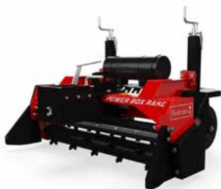
**Travaillez, ratissez, nivelez et retournez** le sol en un seul passage ! Son rotor équipé de **dents en carbure** pulvérise les terres compactes jusqu'à **75 mm de profondeur** et sépare les cailloux / débris de celle-ci. Equipé sur un motoculteur 2 roues de 12CV minimum, son **rotor à double orientation** et ses **plaques latérales rabattables** vous permettent de répartir l'andain sur toute la largeur de la machine.
