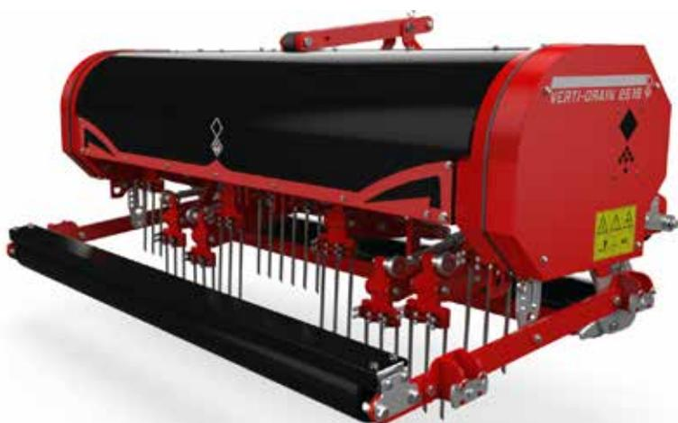
La gamme de Verti-Drain légère rapide apporte un confort de travail inégalé pour aérer et décompacter **à partir de 25CV (7212)**. Ils couvrent de larges surfaces avec une vitesse de travail plus rapide que la gamme standard. Couplée à une **profondeur de pénétration de 25 cm** sur
