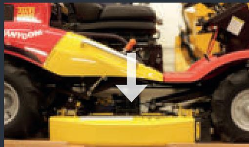
Réglage du plateau de coupe depuis le siège de conducteur en 21 positions assisté par un vérin à gaz.
