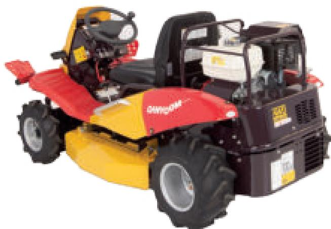
La débroussailleuse CMX1402 est propulsée par un moteur Honda GX390 de 14CV avec une système de filtration « Cyclone Air Cleaner ». La machine possède une double commande à la main ou avec le pied pour une maîtrise parfaite et une sécurité maximale.
