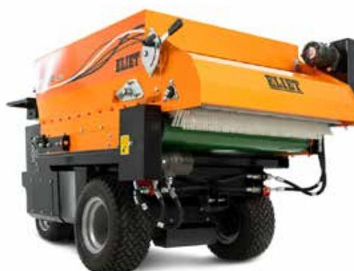
L'EcoCure™ est disponible en version tractée à disques ou à brosse. La version WS («Wide spread») est équipée d'un tapis ameneur de 45 cm pour emmener la matière vers les disques, pour épandre la matière sur 5 mètres de largeur maximum.
