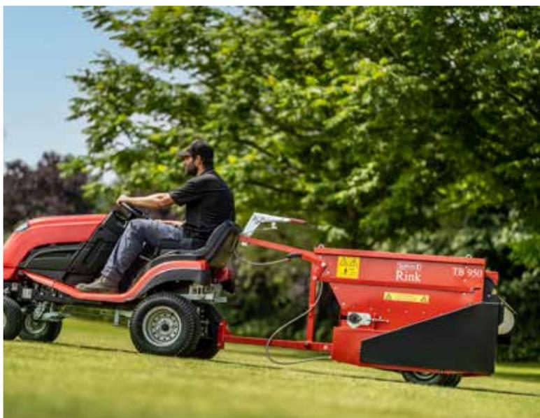
Avec une largeur de gamme complète et solide, les **Rink à brosse** sont une référence sur le marché du sablage. La distribution du sable ou autres matériaux d'épandage est réglable, régulière sur toute la largeur de la machine pour une répartition maîtrisée sur vos terrains (après aération, décompaction, défeutrage, ...).
