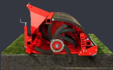
Les lames des Verti-Quake s'enfoncent alternativement dans le sol sur toute la largeur de la machine pour découper des sections verticales tout en vibrant horizontalement. Chaque section est bousculée par le passage des lames en décalé à sa droite et à sa gauche d'où l'effet de « décompaction ».
