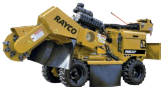
La version la plus puissante de Super JR possède un moteur 37CV et le système de balayage exclusif Rayco. Sa transmission est idéalement située pour maximiser la visibilité des opérations et elle permet un franchissement plus aisé des portails lorsque le bras est aligné.
