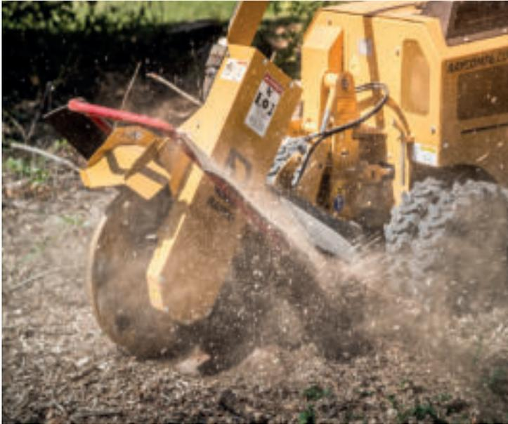
La tête de rognage et les dents Rayco dispose d'un angle différent ce qui permet d'augmenter la performance de rognage tout en diminuant la puissance nécessaire.
