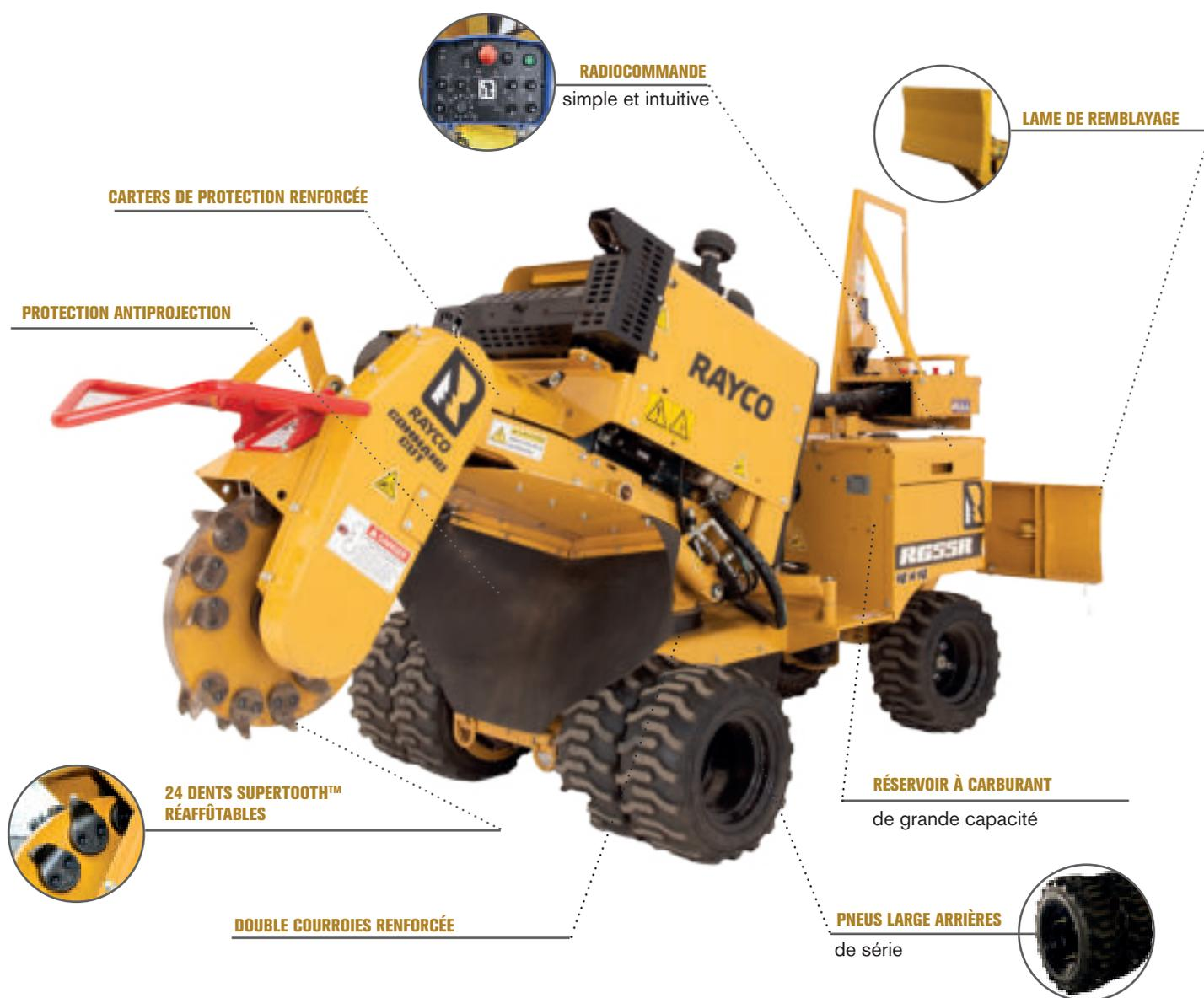
Les rogneuses de souches Rayco RG55 sont conçus pour répondre à tous types de besoins des professionnels tout en restant compactes et maniables. Elles allient rendement de travail, robustesse, confort et sécurité pour un coût d'utilisation réduit. Le système de Command Cut est installé de série.
